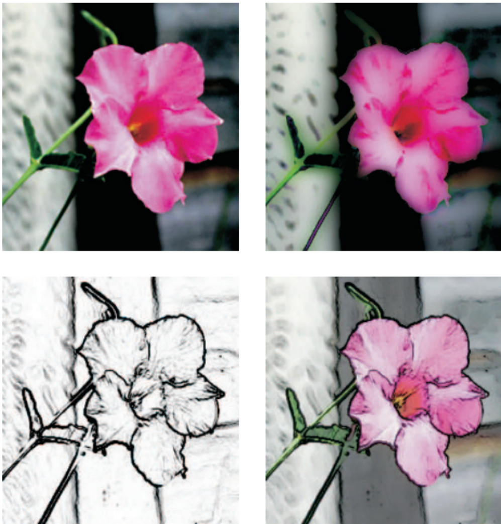
图 12.5：使用像素着色器进行图像处理操作。其中左上角为原始图像，在其基础上进行了各种处理。右上角为高斯差分运算（Gaussian difference operation），左下角为边缘检测，右下角为边缘检测与原始图像混合后的合成图像。
