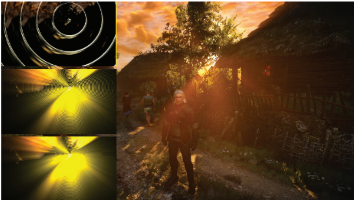
图 12.8：游戏《巫师 3》中生成太阳光晕的过程。首先，对输入图像应用一个高对比度的校正曲线，从而分离太阳未被遮挡的部分。接下来，对图像应用以太阳为中心的径向模糊。如左侧图像所示，模糊是以一系列方式进行执行的，每次模糊都是基于前一次模糊的输出结果。这样做可以创建一个平滑的、高质量的模糊，同时可以在每个 pass 中使用有限数量的样本来提高效率。所有的模糊操作都是在半分辨率下进行的，从而减少时间开销。最终生成的光晕图像会与原始场景渲染的结果进行叠加。
